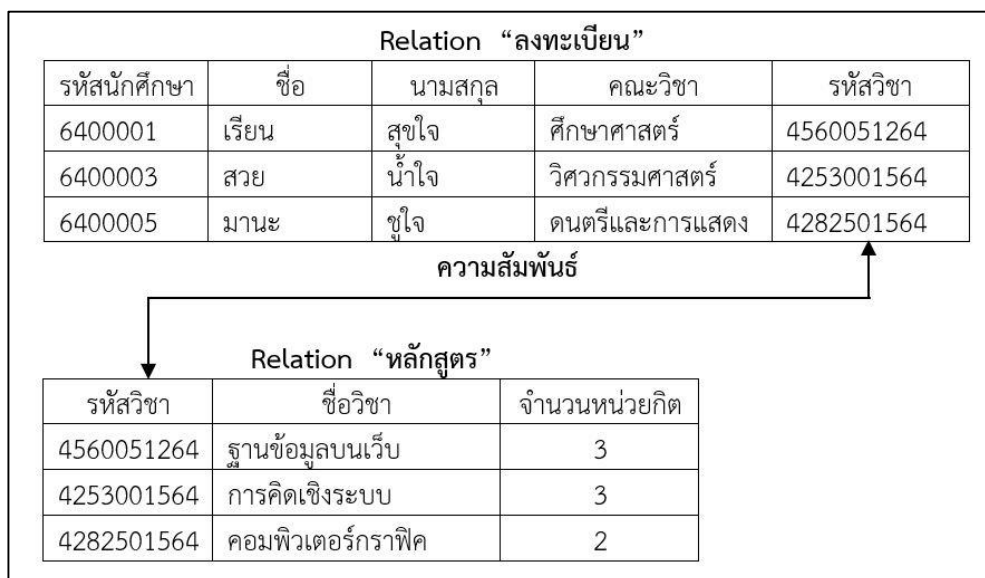
ภาพที่ 3.15 ความสัมพันธ์ของแบบจำลองฐานข้อมูลเชิงสัมพันธ์
